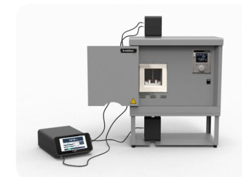
Sistema para ensaio de materiais em temperatura elevada com base na Técnica de Excitação por Impulso (IET).
