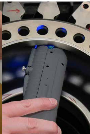
Medições dentro de uma flange
