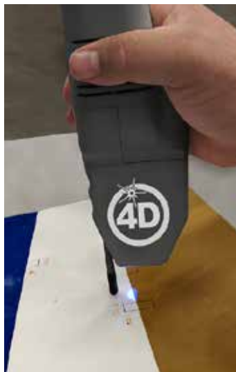
Medição de espessura de camadas
