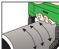
Energize o Yoke. O campo magnético irá se formar sobre a peça.
