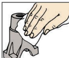
Aplique uma porção de limpador num pano e remova o penetrante ou lave com água.
