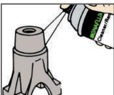
Faça uma pré-limpeza na área de inspeção. Aplique o Limpador e esfregue com um pano.
