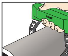
Posicione o Yoke sobre a parte a ser ensaiada perpendicularmente a suposta direção das trincas.
